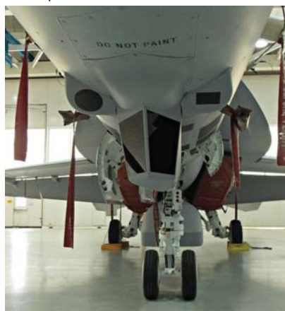
Подstrupни увлачиви оптикоелектронски сензор на авиону Advanced Super Hornet
