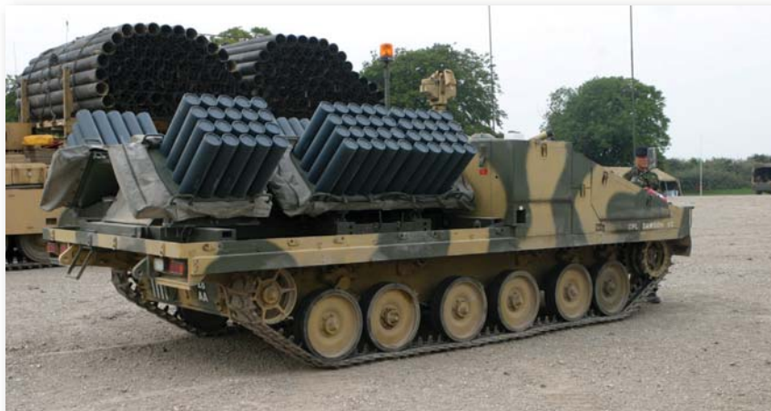
Гусенични минополагач Shielder са америчким системом Volcano
