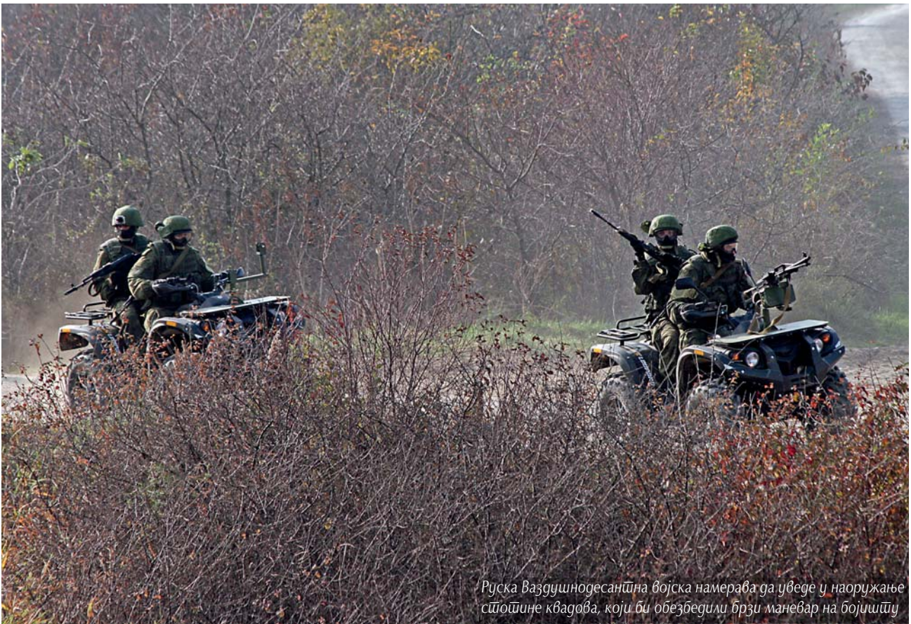
Квад који користе руски десантници покреће мотор кинеске производње снаге 29 kW (39 КС)
