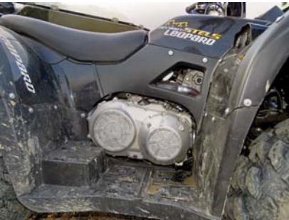
Квад који користе руски десантници покреће мотор кинеске производње снаге 29 kW (39 КС)
